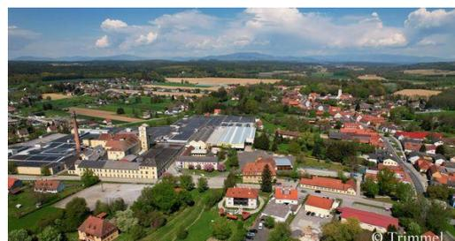
Mit einer Leistung von rund 3,6 MWp wird auf einer Dachfläche von rund 60.000 m<sup>2</sup> erneuerbarer, grüner Strom für rund 1.100 Haushalte produziert, ohne wertvollen Boden zu versiegeln.
